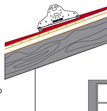
В месте установки элементов безопасности кровли необходимо применять сплошную обрешетку согласно актуализированной версии СНиП II-26-76 «Кровли».
